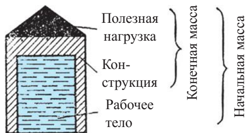
Рис. 114. Структурная схема ракеты.
