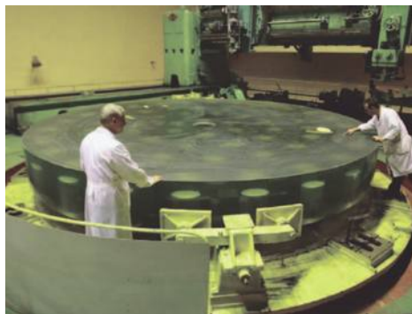
Рис. 38. Процесс шлифовки зеркала телескопа диаметром 8 метров.
